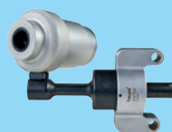
Πάνω αριστερά: προσαρμογές για την πρέσα Haupa για να μπορούν να χρησιμοποιηθούν οι εναλλασσόμενες κεφαλές για το Smart Universal (δεξιά).
